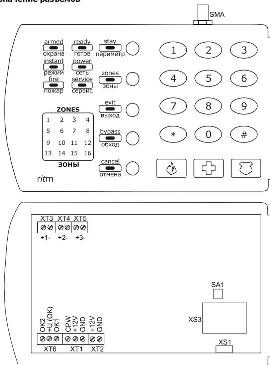
SMA - разъем предназначен для подключения внешней GSM-антенны (отсутствует у устройств со встроенной антенной).
