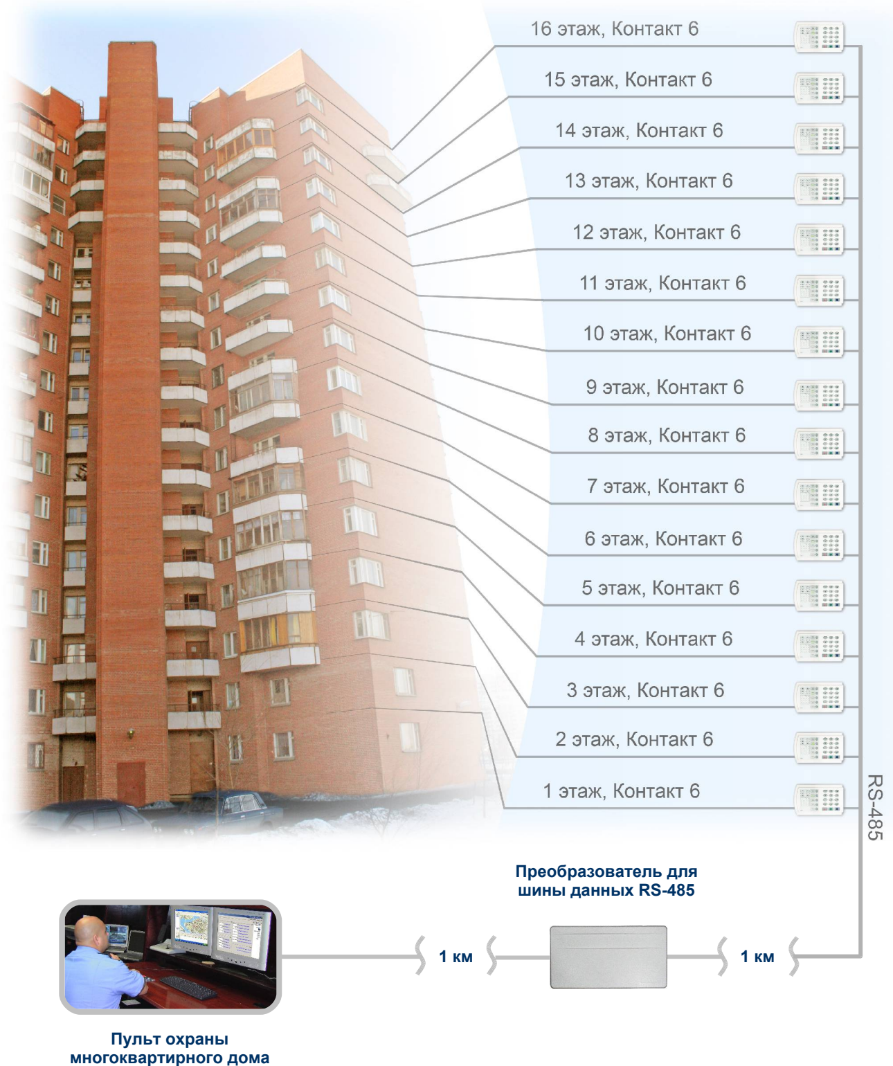
Рис.6.1. Принцип работы преобразователя RS-485 с гальванической развязкой.
