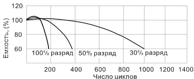
Срок службы аккумуляторов в циклическом режиме работы зависит от целого ряда факторов. Наиболее существенными из них являются рабочая температура окружающей среды, скорость разряда, глубина разряда и способ заряда. На рисунке 8 показано влияние глубины разряда на количество циклов работы моноблоков Delta серии DT при циклическом режиме.
