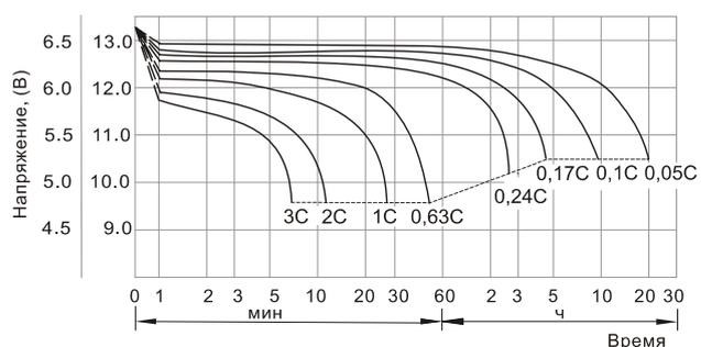
На рисунке 3 приведены кривые разряда аккумуляторов Delta серии DT постоянным током до определенного конечного напряжения. Разряд до напряжения ниже указанного снижает емкость и срок службы свинцово-кислотных батарей.
