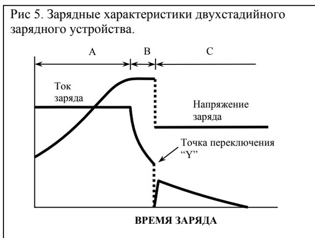
На стадии «А» ток ограничен величиной 0,25 СА, а напряжение на клеммах батареи растет. На стадии «В» зарядный ток начинает падать, а напряжение стабилизируется на уровне 2,45 В/эл-т. На этой стадии уровень заряда аккумулятора достигает 80%. При достижении зарядным током уровня «точки переключения У» зарядная цепь переключается на стадию «С», где зарядное напряжение падает с 2,45 до 2,30 В/эл-т, а ток плавно снижается практически до нуля. Зарядное устройство переходит в буферный режим.
