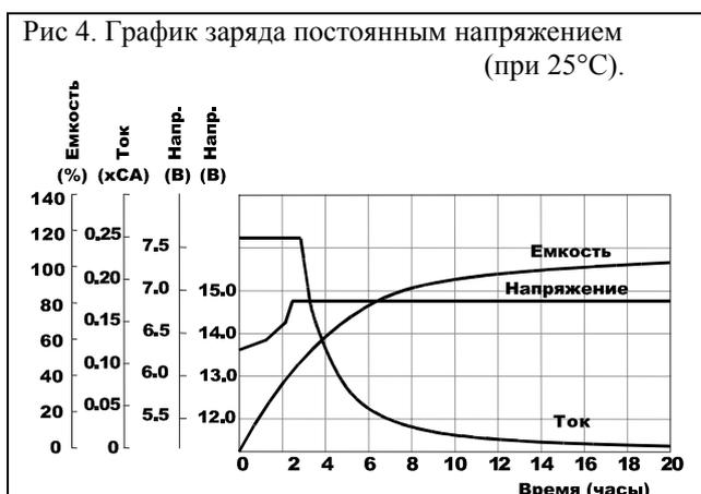
Для моноблоков Delta серии DT диапазон зарядного напряжения буферного режима установлен в диапазоне 2,27–2,30 В/эл-т (при 25°C).
