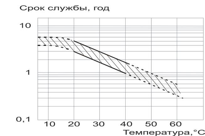
Температура окружающей среды является важным фактором, влияющим на срок службы аккумуляторов. При повышении температуры увеличивается скорость коррозии пластин, вследствие чего уменьшается срок службы. На рисунке 10 показана зависимость срока службы батарей Delta серии DT от температуры окружающей среды.
