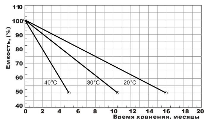
Свинцово-кислотные аккумуляторы обладают саморазрядом, вследствие чего при хранении их доступная емкость со временем уменьшается. Этот процесс описан графиком на рисунке 11.
