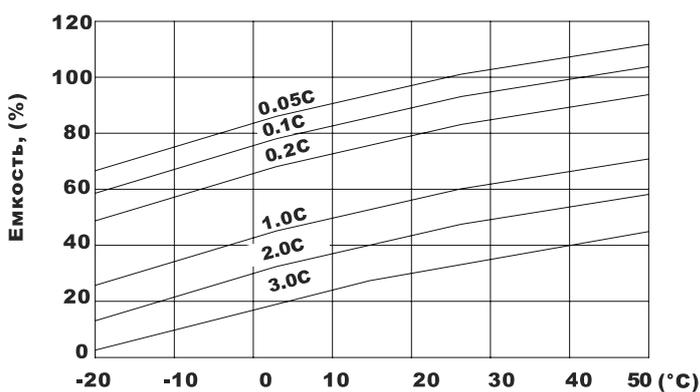
По мере повышения температуры электрохимическая активность аккумулятора возрастает, а при понижении — падает. Поэтому при увеличении температуры окружающей среды емкость аккумулятора увеличивается, а при понижении температуры — уменьшается. Рисунок 9 демонстрирует влияние температуры на доступную емкость моноблоков Delta серии DT.
