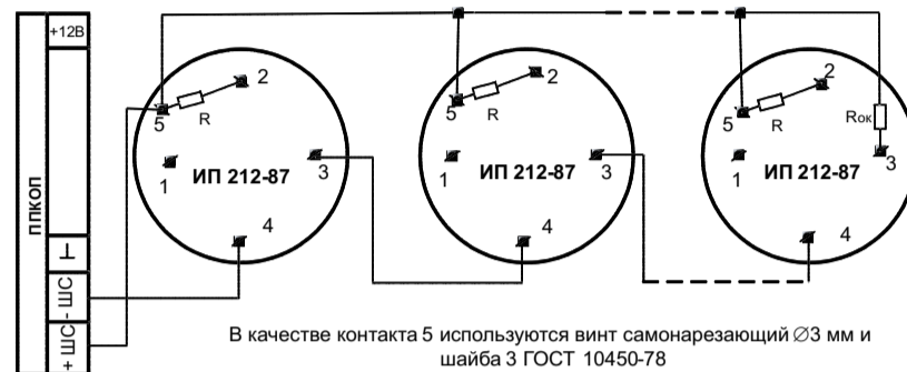
Схема подключения извещателей к приемно-контрольному прибору с использованием добавочного резистора
