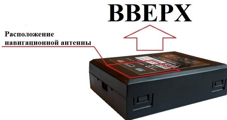
Рисунок 4 – Положение устройства при установке
