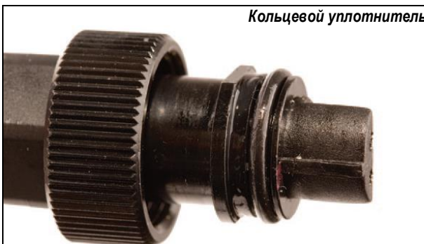
Для работы под водой смажьте уплотнительное кольцо
