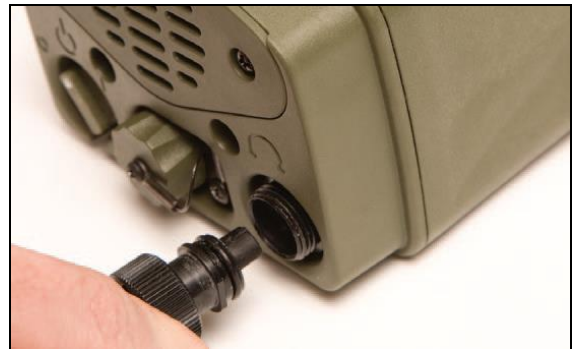
Совместите штекер с контактами разъема и вставьте его до упора.
