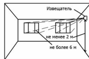
Рис.2. Установка извещателя на боковой стене
