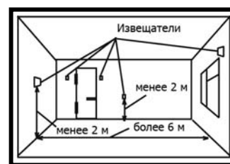
Рис.6. Некорректные варианты установок извещателей
