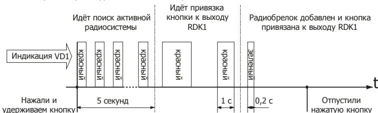
Если по какой-то причине радиобрелок не может добавиться в систему, индикатор сигнализирует красным непрерывным светом в течение 3-х секунд, затем индикация пропадает:
