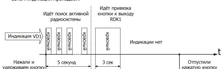
Если к этому же выходу «RDK1» необходимо привязать и другие кнопки радиобрелока, нажмите и удерживайте нужную кнопку до короткого зелёного сигнала светодиода VD1, а затем отпустите. Если же необходимо привязать кнопки к другому выходу, то заново переведите радиоканальный приёмник «RDK1» в режим ручного добавления устройств в радиосистему с другим положением перемычек:
