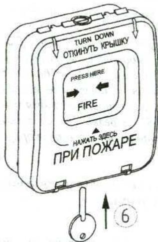
Для приведения извещателя в исходное состояние после срабатывания вставьте толкатель, прилагаемый к извещателю, в отверстие на нижнем торце извещателя и двигайте его вверх (6), до щелчка.
