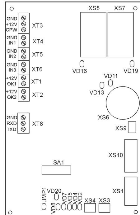
XT1 — клеммы непрограммируемого выхода №1 с открытым коллектором для подключения внешних исполнительных устройств (например, реле). Максимальная нагрузка 300 мА.
