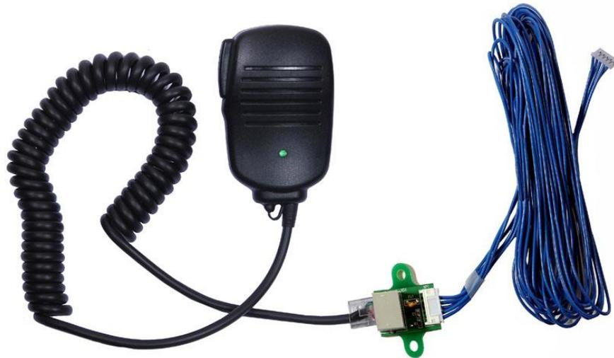
Рис.42. Блок диспетчерской связи с тангентой
