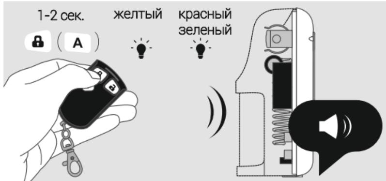
Добавьте дополнительные брелоки (при наличии). Поочерёдно нажмите на брелоках кнопку («A»). На каждый добавленный брелок сигнализатор издаст звуковой сигнал. Всего можно добавить 5 дополнительных брелоков.
